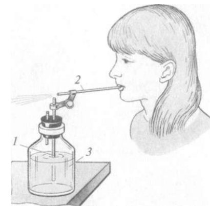
Рис. 31. Пульверизатор: ; _ распылитель; 2 - трубка; 3 - со суд с жидкостью
