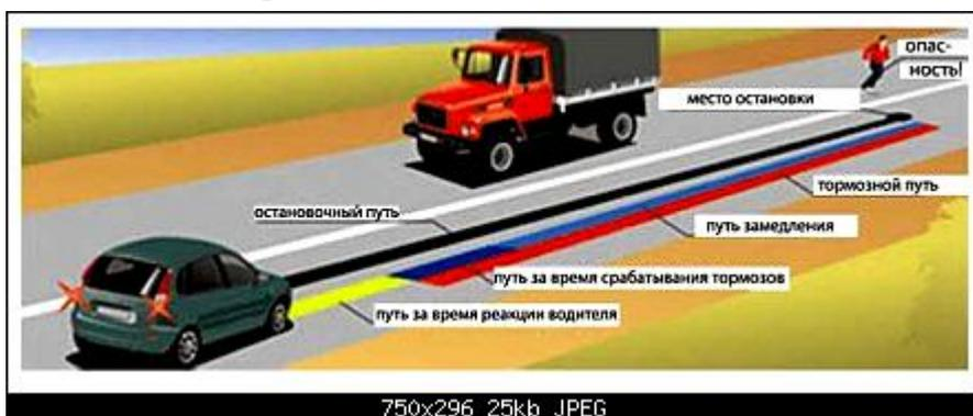
То расстояние которое автомобиль пробегает с момента обнаружения водителем опасности, до полной остановки, получило название **остановочный путь**.
