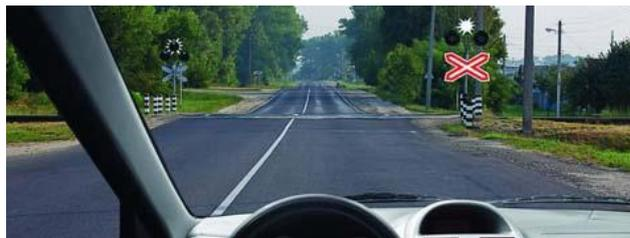
Рис. 9.9. Светофор для регулирования движения через железнодорожные переезды
