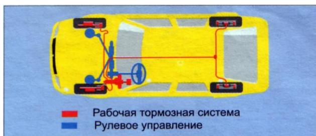
Рис. 4.4. Тормозная система;
