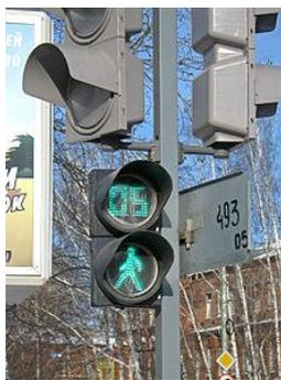
Рис. 3.9. Светодиодный светофор для пешеходов с обратным отсчётом времени
